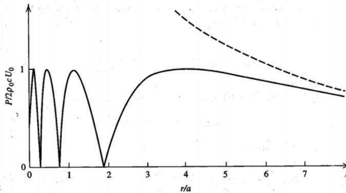
Module de la pression rayonnée dans l'axe à haute fréquence. La courbe pointillée correspond à l'approximation « champ lointain ».
