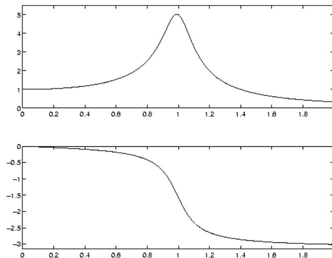
*Réponse en amplitude (courbe du haut ; unité arbitraire) et en phase (courbe du bas ; en radians) en fonction de la fréquence adimensionnée  $u$ .*
