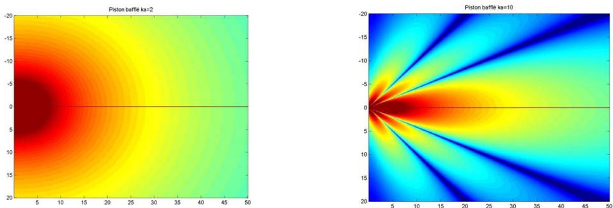
*Figure de rayonnement d'un piston plan pour  $ka=2$  (à gauche) et  $ka=10$  (à droite) . La grandeur représentée est le module de la pression.*
